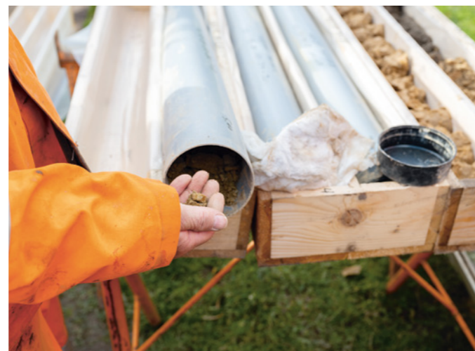
Oben: Bodenproben werden für das Labor in Transportkästen verpackt
