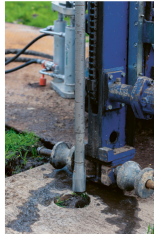
Oben: Dokumentation der Bodenfolge aus dem Hohlgestänge einer Kleinrammbohrung Unten links: Spitze einer Sonde für die Rammsondierung Rechts: Rammkernbohrung zur Erkundung der Schichtenfolge des Bodens
