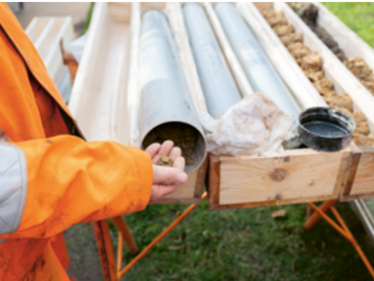
Bodenproben werden für das Labor in Transportkästen verpackt
