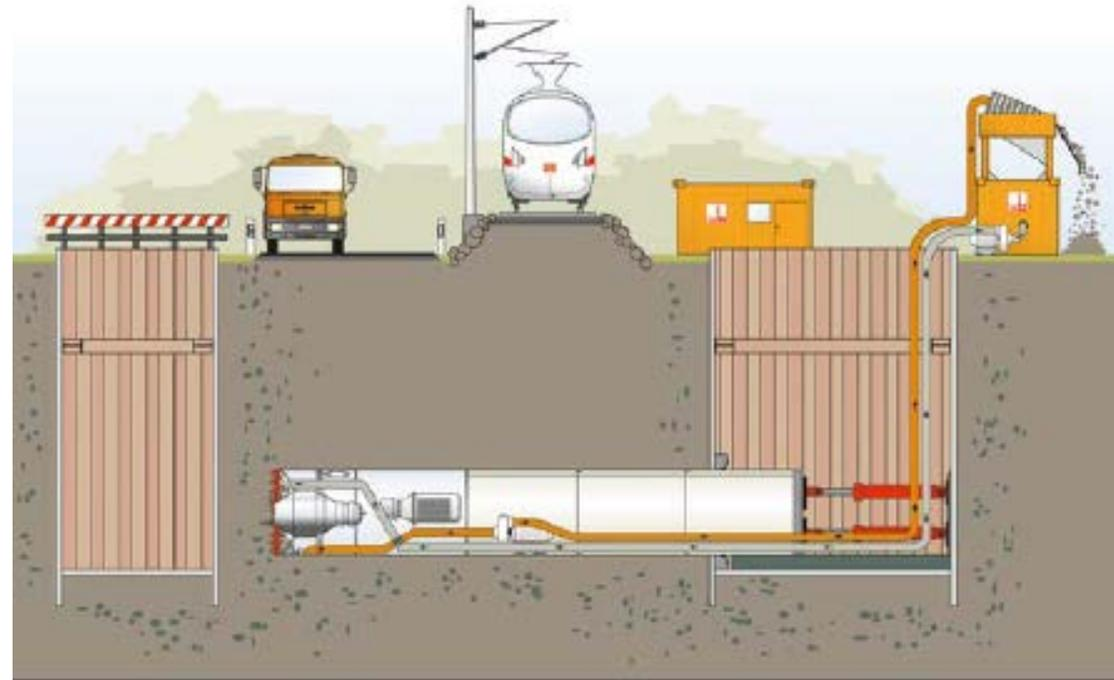
Quelle Amprion | Mikrotunnelbau mit Spülförderung
